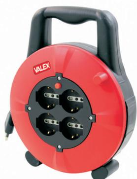
Lunghezza cavo 10m. sezione cavo 3x1,5mm<sup>2</sup>. 4 prese bipasso 10/16a. protezione termica. ripristinabile. spina italiana con contatto di terra, 16a
