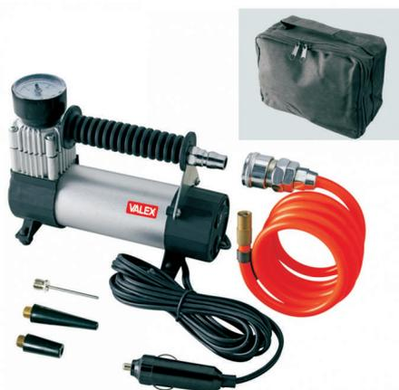
Corpo in metallo, alimentazione 12v (accendisigari), pressione max 8 bar maniglia per trasporto e adattatori gonfiaggio , spirale aria mt 1.
