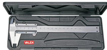
Misurazioni interne, esterne e di profondità, in acciaio opaco antiriflesso, bloccaggio a vite, guide di scorrimento rialzate, dimensioni totali 230x75x7mm, lettura utile 155mm. calibro cinquantesimale.
