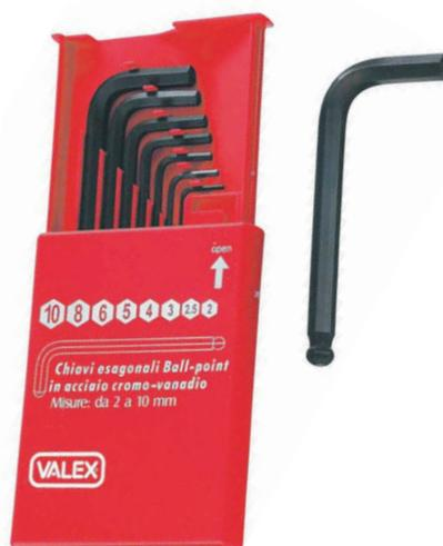
In acciaio cromo - vanadio brunito. con scatola a cassetto in plastica. misure impronta x lunghezza: 2x50 - 2,5x58 - 3x65 - 4x75 - 5x83 - 6x95 - 8x105 - 10x120mm.
