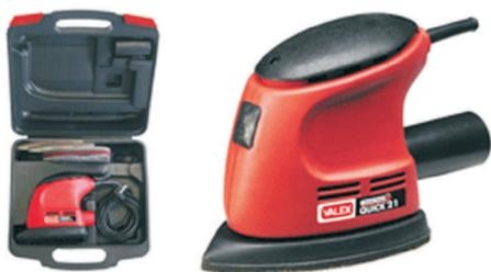
Potenza w 105 - oscillazioni /min 12000 piastra mm 140x100 fissaggio carta velcro peso netto kg 0,7
