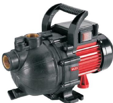
Potenza 600w - portata max 2800 l/h - acqua gradi max 35 - prevalenza max 35 m - altezza aspirazione max 7 m , tenute in ceramica attacco aspirazione e mandata da 1" maschio - peso netto kg. 5,8
