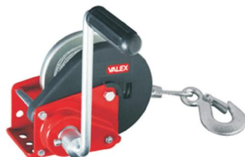
In acciaio zincato , con freno automatico e protezione ingranaggi. completo di fune acciaio 4,5 mm x 10 mt ,rapporto riduzione 5,08.
