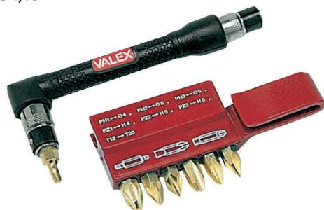
Dimensioni 110x35mm, 7 inserti doppi in acciaio cromo - vanadio con finitura dorata, tipo flat, phillips, pozidrive, esagonale, torx, custodia in pvc con clip di fissaggio.
