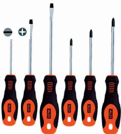
Impugnatura ergonomica per una migliore presa. manico bicomponente in polipropilene rivestito di materiale antiscivolo per una migliore torsione. stelo cromato in acciaio al cromo - vanadio, punta magnetica brunita. punta flat 0,5x3x75 - 0,8x4x100 - 1x5,5x125mm, pozidrive 0x3x60 - 1x4,5x75 - 2x6,5x100mm.
