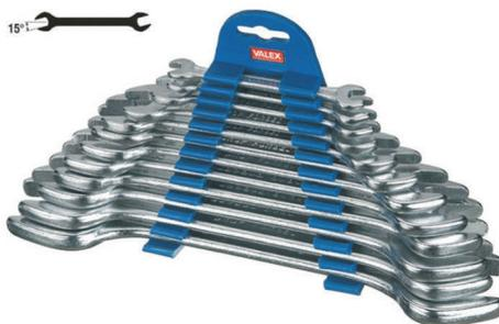
In acciaio forgiato. finitura cromata. forchette inclinate di 15°. misure apertura/ lunghezza: 6x7/95, 8x9/100, 10x11/110, 12x13/125, 14x15/145, 16x17/160, 18x19/180, 20x22/200, 21x23/210, 24x27/225, 25x28/235, 30x32/250mm.
