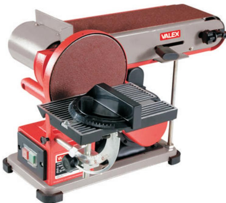
potenza W 375 - giri nastro 276m/min - nastro mm 910x100 allineamento nastro manuale - disco giri 1475 min. - disco diam. 150 mm piano nastro inclinabile 0/90° - piano del disco inclinabile 0/45°
