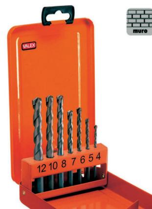
Angolo taglienti 135°. alta resistenza, placchetta in metallo duro. misure:  $\varnothing 4 - 5 - 6 - 7 - 8 - 10 - 12\text{mm}$ . lunghezza 74 - 120mm.
