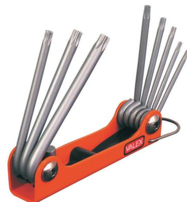
In acciaio cromo - vanadio. estremità smussate per un perfetto accoppiamento con la vite. misure impronta x lunghezza: 2,5x53 - 3x62 - 4x68 - 5x72 - 6x74 - 7x80 - 8x87 - 10x96mm.
