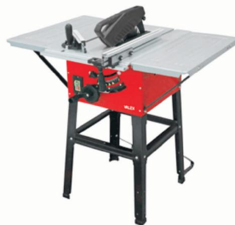
Potenza: 2000 watt • nr. giri: 4800 / min alt. taglio: 0°:73 mm - 45°: 55 mm • dim. del piano: 630 x 430 mm-lama: Ø 250 x Ø 30 Z24 Fornito con 2 prolunghe laterali 620x255 mm, squadra e goniometro. guida parallela e piedistallo.
