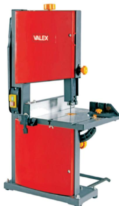
Potenza: 250 w - nr. giri: 1475 min - velocità - lama: 950 m/min. Altezza taglio: 59 mm a 45°, 80 mm a 0° profondità taglio 200 mm. Dimensione piano: 300 x 300 mm Peso prodotto: 20 kg
