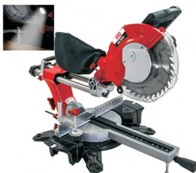
Potenza: 2000 watt • nr. giri: 4.500 /min-lama dimen. 250x30mm Z36 - peso netto kg.14, testa inclinabile da 0 a 45 gradi, piano girevole 0-45 gr. Taglio a 0 gradi 85x340 mm, a 45 gr.85 x 230. Taglio inclinato 0 gr.50x340 mm - inclinato 45 gr. 50 x 230. Dimensioni 500x760x510 mm
