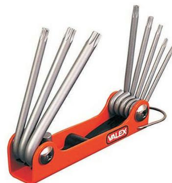
In acciaio cromo - vanadio. finitura satinata. estremità smussate per un perfetto accoppiamento con la vite. misure impronta x lunghezza: t9x56, 10x61, 15x66, 20x70, 25x74, 27x77, 30x85, 40x91mm.
