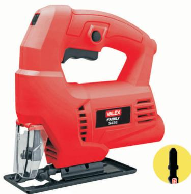
Potenza: 450 watt• giri a vuoto 500 - 3000 min taglio inclinato da 0° a 45° cambio lama con utensile - blocco interruttore - soffiaggio anteriore trucioli velocità variabile con preselezione del numero di giri.
