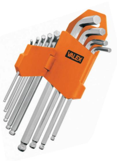
In acciaio cromo - vanadio, finitura satinata. estremità smussate per un perfetto accoppiamento con la vite. Misure impronta x lunghezza: 1,5x80 - 2x85 - 2,5x95 - 3x100 - 4x110 - 5x120 - 6x145 - 8x165 - 10x180mm.
