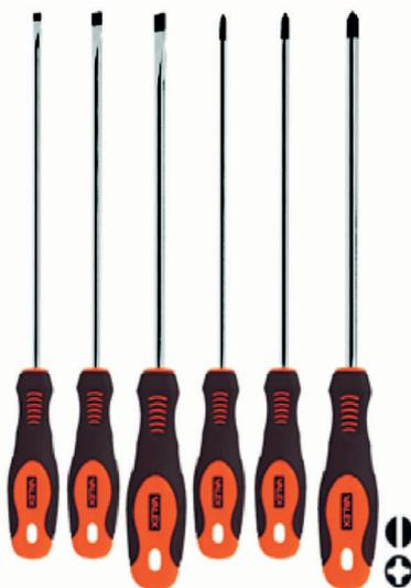
Manico bicomponente in polipropilene rivestito di materiale antiscivolo. stelo cromato in acciaio al cromo - vanadio, punta magnetica brunita. punta flat ad intaglio 0,5x3x200 - 0,8x4x200 - 1x5,5x200mm, phillips 0x3x200 - 1x4,5x200 - 2x6,5x200mm.
