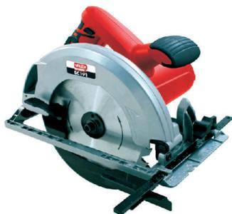
Potenza W 1400 - corse a vuoto /min 4700 - dimensione lama 190x20 mm Z24 - taglio mm 0-65 - taglio inclinato da 0/45° - interruttore di sicurezza contro l'accensione accidentale - piastra di appoggio in alluminio
