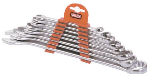
In acciaio forgiato. finitura cromata. teste inclinate di 15°. misure apertura x lunghezza: 8x120, 10x140, 11x150, 13x170, 14x180, 17x210, 19x235, 22x265mm.
