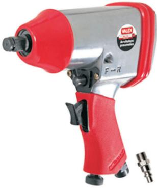
Pressione di utilizzo 6,3bar - reversibile - attacco rapido - torsione max 320nm consumo aria: 110 l/min - dimens. filettatura max: m14 peso: 2,3 kg - attacco quadro 1/2" -
