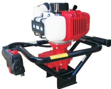
Motore 2t catalizzato , alimentazione miscela 3% .cilindrata 52 cc. sistema antishock , trasmissione ingranaggi , scatola riduzione in alluminio. avviamento facilitato , peso netto 11,5 kg.
