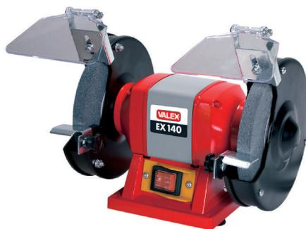
Potenza: 150 Watt - Nr. giri vuoto 2950 min - Diametro esterno mola 150mm diametro foro mm 12,7 - mola spessore mm 16 - grana mole 36/60 peso netto kg. 5,5
