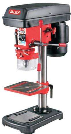
Motore 350 w 220 v , velocità albero 1480 g/min 5 velocità mandrino cremagliera di 13 mm, capacità foratura max 50 mm altezza 57,5 cm, peso 12,5 kg
