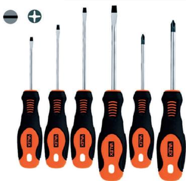
Impugnatura ergonomica per una migliore presa. manico bicomponente in polipropilene rivestito di materiale antiscivolo per una migliore torsione. stelo cromato in acciaio al cromo - vanadio, punta magnetica brunita. punta flat 0,5x3x75 - 0,8x4x100 - 1x5,5x125mm, pozidrive 0x3x60 - 1x4,5x75 - 2x6,5x100mm.
