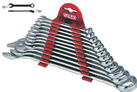
In acciaio forgiato. finitura cromata. teste inclinate di 15°. misure apertura x lunghezza: 6x100, 7x110, 8x120, 9x130, 10x140, 11x150, 12x160, 13x170, 14x180, 17x210, 19x230, 22x260mm.
