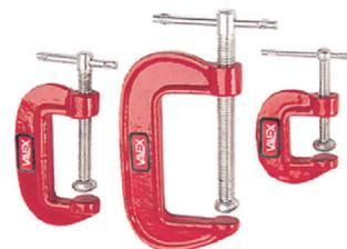
In acciaio verniciato con ganasce in ghisa, apertura x profondità di presa: 21x24mm, 46x29mm, 71x40mm.
