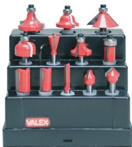
6 per scanalare: 3 dritte, coda di rondine, per gole rotonde, conica a 'v'. 6 per rifilare: dritta, 2 a raggio concavo, raggio convesso, sagoma roman, conica. in acciaio con 2 taglienti in widia, codolo 6mm.
