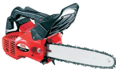
Motore 2t catalizzato 25,4 cc - barra 10' (250mm), accensione elettronica catena 3/8' lp - 050' - 1,3mm - 40mm - velocita 20 m/sec
