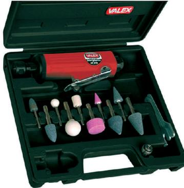
Pressione di alimentazione 6,2bar, mandrino da 6mm, consumo aria 330l/min, in valigetta con 10 molette in dotazione.
