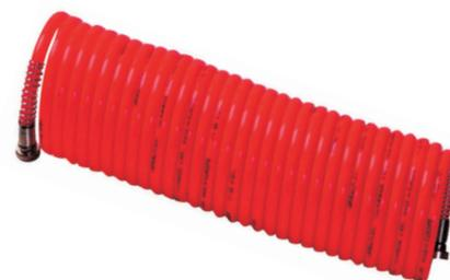
Diametro esterno tubo 8mm, diametro interno 6mm. attacco a baionetta, pressione massima di utilizzo 10 bar.
