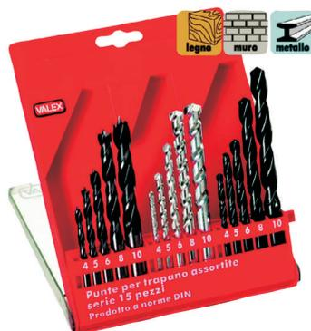
$\varnothing 4 - 5 - 6 - 8 - 10\text{mm}$  angolo taglienti 118°, 5 punte per legno  $\varnothing 4 - 5 - 6 - 8 - 10\text{mm}$ , 5 punte per muro  $\varnothing 4 - 5 - 6 - 8 - 10\text{mm}$  angolo taglienti 130°. lunghezza 73 - 130mm.
