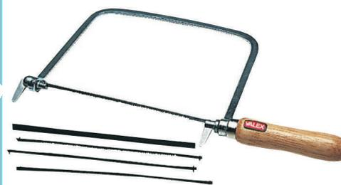
Struttura in acciaio brunito con impugnatura in legno, 5 lame in acciaio carbonio in dotazione
