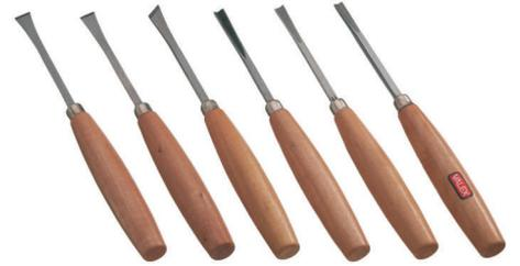
Lama in acciaio, taglio frontale doppia affilatura 84x10mm, taglio frontale arcuato 84x10mm, taglio frontale inclinato doppia affilatura 87x10mm, taglio frontale inclinato 83x7mm, taglio frontale concavo 85x8mm, taglio frontale concavo arcuato 85x6mm. lunghezza totale 200 mm.
