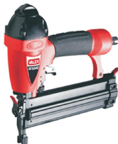
Pressione di utilizzo 6,2br - capacità serbatoio 100 chiodi/punti - corpo in alluminio - per punti da h. mm13 a mm 40 - per chiodi da h. mm 12 a mm. 50 - attacco rapido peso circa kg. 2,6
