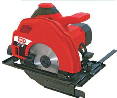
Potenza W 800 - corse a vuoto /min 4600 - dimensione lama 140x16 mm Z18. Piastra di appoggio in acciaio - interruttore di sicurezza contro l'accensione accidentale - peso netto kg 2,6
