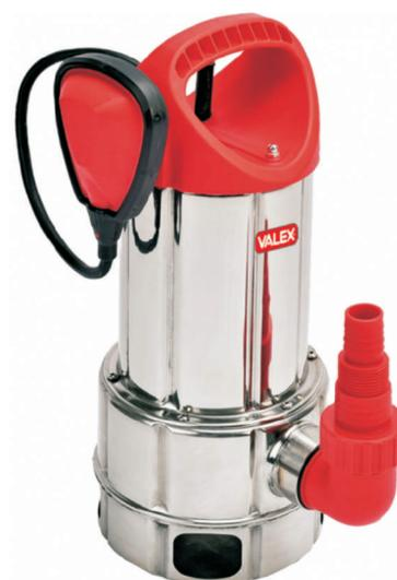
Potenza: 550 watt • portata: max 10.500 l/h • prevalenza: 7 mt max profondità immersione: 7 mt, max dim. solidi 35 mm , tipo di tenuta: ceramica - acqua gradi max 35° - dim. l16x p18xh38 livello minimo di aspirazione 40mm. - acque torbide - corpo in acciaio inossidabile - peso netto 4.6 kg
