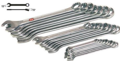
In acciaio cromo - vanadio. finitura cromata. teste inclinate di 15°. misure apertura x lunghezza: 6x100, 7x110, 8x120, 9x130, 10x140, 11x150, 12x160, 13x170, 14x180, 15x190, 16x200, 17x210, 18x220, 19x230, 20x240, 21x250, 22x260, 23x270, 24x280, 26x300,
