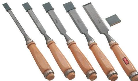
Lama in acciaio carbonio, manico in legno con ghiera in metallo, larghezza punta x lunghezza totale: 8x240, 12x240, 16x247, 20x247, 24x247mm.
