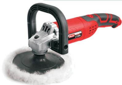
Potenza 1150w - giri/min a vuoto 1150/3000 - disco diam mm. 180 peso netto kg 2,7 - fornita con pialtello attacco velcro e cuffia in lana con dispositivo anti avviamento accidentale.
