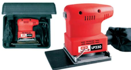
Potenza 180w. doppio piano di lavoro: 100x110mm e 155x110mm per superfici inaccessibili (ideale per persiane). numero oscillazioni 10000g/min. peso 1,4 kg. corpo compatto per levigare a filo su tre lati. aspiratore integrato per convogliare le polveri nel sacchetto di raccolta.
