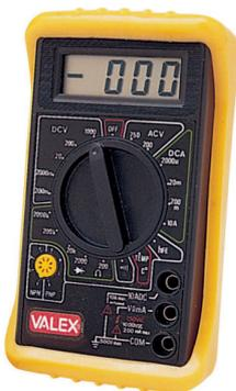
Lettura digitale - altezza caratteri (mm): 13 mm - rilevam. c.c. - corrente max. (a): 10 a - rilevam. c.c. - tensione max. (v): 1000v rilevam. c.a. - tensione max. (v): 750v
