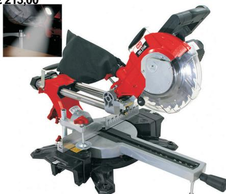
Potenza: 1.800 watt • nr. giri: 4.500 /min -lama dimen. 216x30mm Z24 - peso netto kg.13, testa inclinabile da 0 a 45 gradi, piano girevole 0-45 gr. - taglio a 0 gradi 65x340 mm a 45 gr.65 x 230, taglio inclinato 0 gr.36x340 mm - inclinato 45 gr. 36 x 230. Dimensioni 500x740x500 mm
