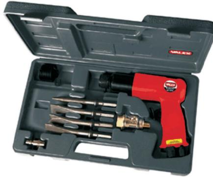
Pressione alimentazione 6,2bar, consumo aria 180lt/min, percussioni 4500c/min. 4 scalpelli 125mm attacco esagonale in dotazione. in valigetta.
