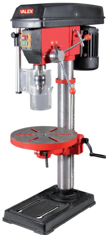
Potenza: 450 watt - inclinazione piano: 0° a +45° - nr. velocità 16 - giri a vuoto 200 - 2900 al min. - mandrino mm 16 - attacco mandrino b16 cm2 - corsa mandrino 80 - piano lavoro mm 290 - diam. colonna mm 72 - peso kg. 40,60
