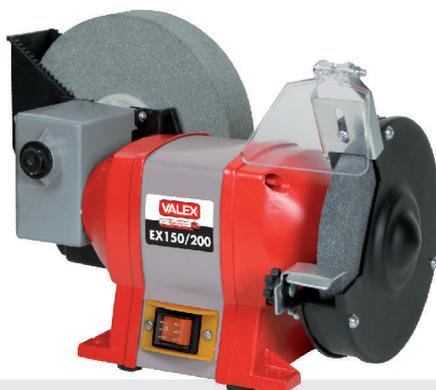
Potenza: 250 Watt - Nr. giri vuoto 2950 min - Diametro esterno mola 150mm diametro foro mm 12,7 - mola spessore mm 20 - grana mola 36 peso netto kg. 8,9 - mola ad acqua 134 giri/min. diam 200x20x40 mm grana 80
