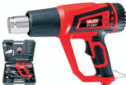
Potenza 1000/2000w - temperatura °c 350 - 600 - flusso aria 480 lt/min peso netto kg. 0,80 , fornito con valigetta completa di 4 accessori e 1 raschietto.
