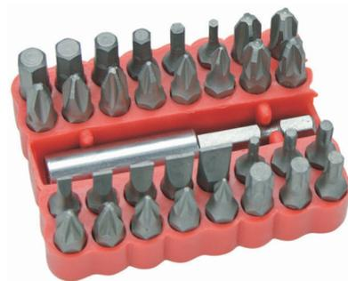
Attacco esagonale da 1/4" - nr.5 inserti per viti con intaglio 3 - 4 - 5 - 6 - 7, r.7 pozidriv 0 - 1 - 2 - 3, nr.8 phillips 0 - 1 - 2 - 3, nr.6 esagonale 2 - 3 - 4 - 5 - 5,5 - 6, nr.6 torx t10 - t15 - t20 - t25 - t30 - t40 portainseri magnetico
