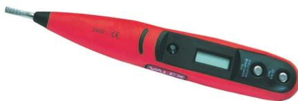
Per rilevare tensioni alternate e continue. permette di identificare cavi di terra e linee interrotte. funziona senza batterie. luce di segnalazione e display digitale di lettura voltaggio. impugnatura isolata antiscivolo, punta flat 3,5mm, lunghezza tota
