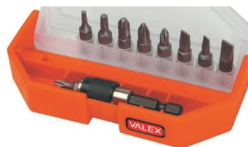
9 inserti in acciaio cromo - vanadio s2 con finitura satinata, tipo flat, phillips e torx, portainseri magnetico a sgancio rapido, custodia dimensioni 115x55x20mm.
